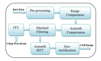
Fig. 1. RDA Block Diagram.
